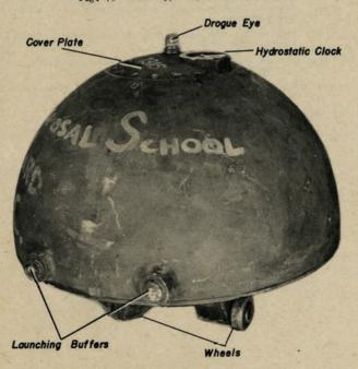
Fig. 71 - Mine Type CH
